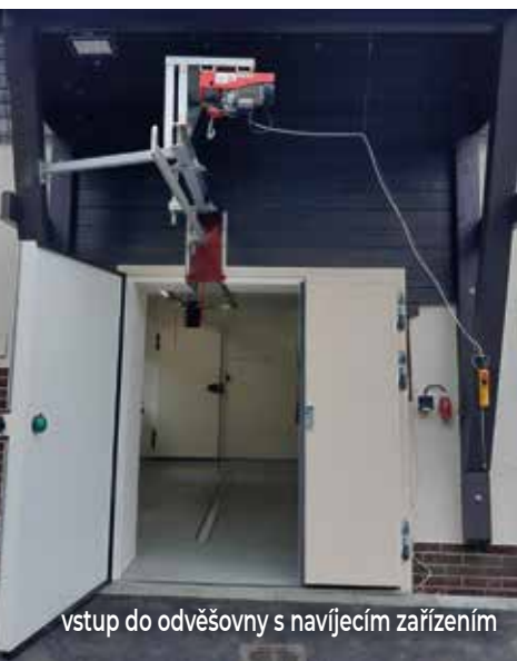
Chladicí místnost. Veškerá manipulace se zvěřinou probíhá automatizovaně pomocí stropních lyžin.
