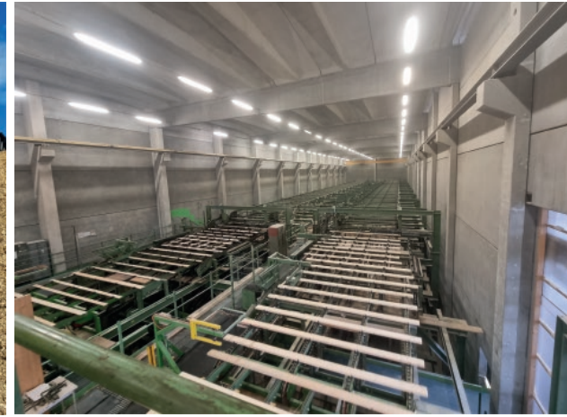
Automatická adjustace řeziva. Část linky obsluhují ženy.
