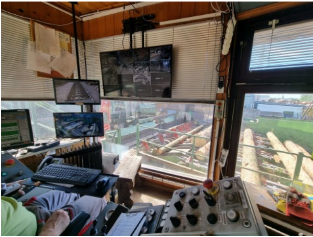
Dříví po přejímce putuje na odkorňovací linku s 3D skenerem a detektorem kovů.
